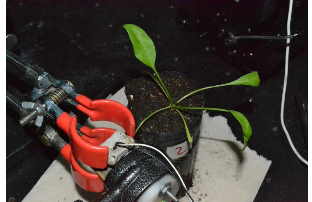
Fig. 3. Sistema para la medición de la razón de evolución de oxígeno (REO).
